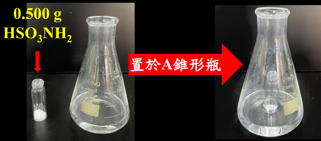
圖七、A 錐形瓶裝置圖
