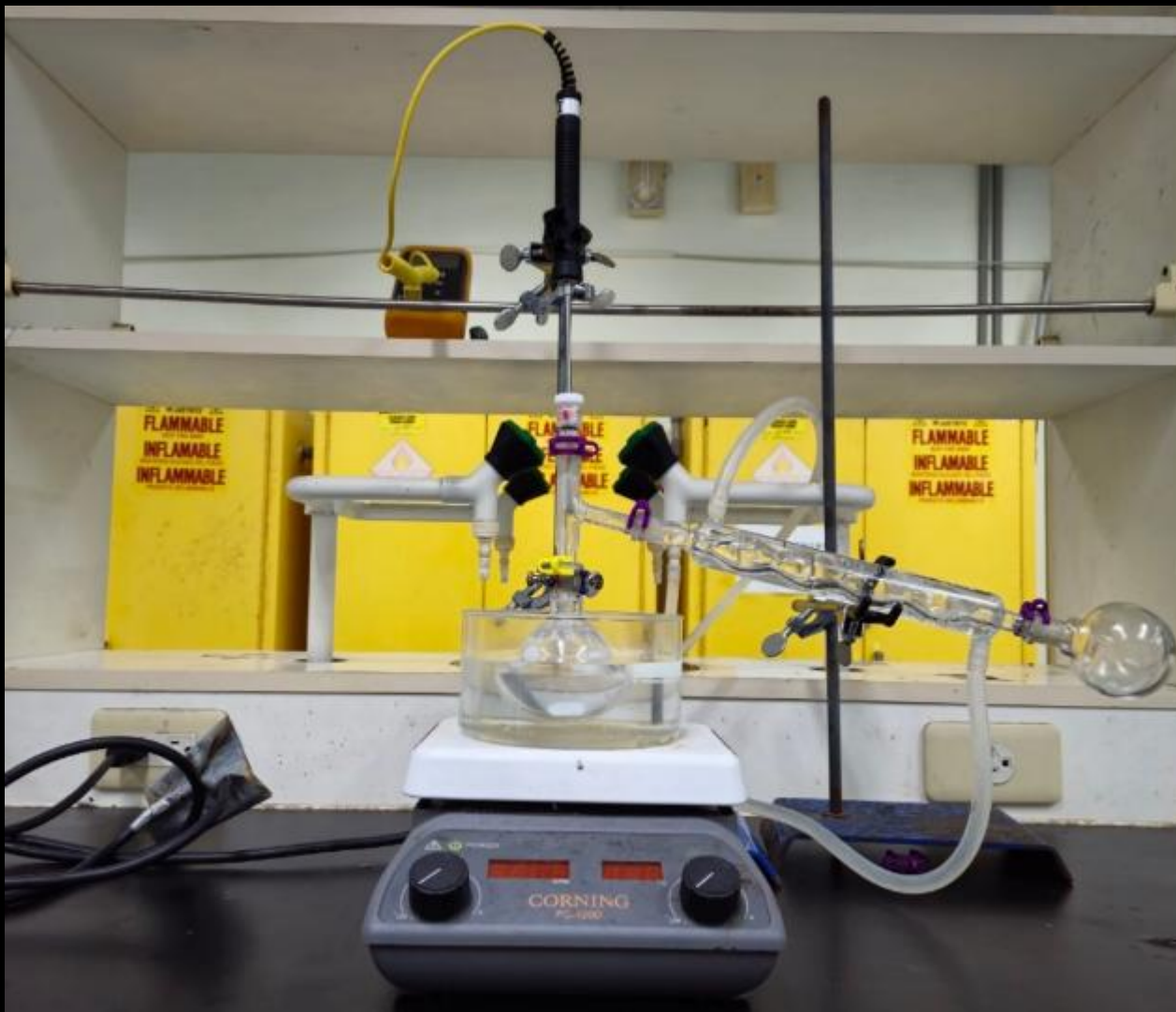
圖七、完成蒸餾裝置
