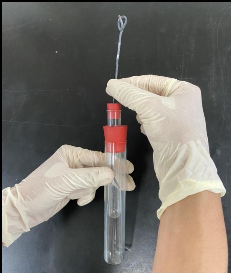
圖九、凝固點測量實驗裝置
