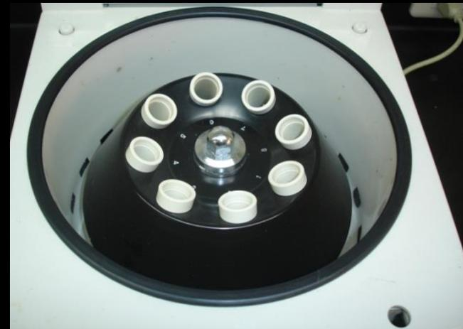
3. 將待分離試樣置於離心管中。離心機中成對的離心管必需保持**等重**，並且以**對角線**方式放置；若離心管的數量不成對，則需要另取一支離心管，裝入約等量的水再放置於對角線的位置，以免造成離心時因力量不平衡而使離心管破裂或旋轉軸受損。
