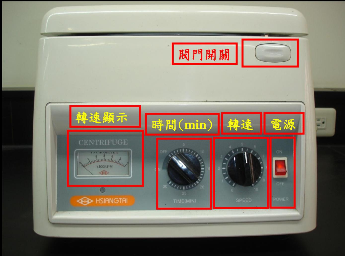
1. 開啟電源，確認離心機為靜止狀態，再按下閥門開關，打開離心機蓋子。**注意!! 電源未開啟時，離心機蓋子無法開啟。**
